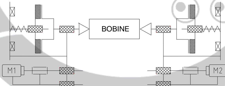
La prise et le positionnement latéral de la bobine se font à l'aide de deux moteurs (M1) et (M2)
